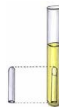
Figura 4: Ejemplo de campana de Durham. Fuente: Ideam, 2020.
