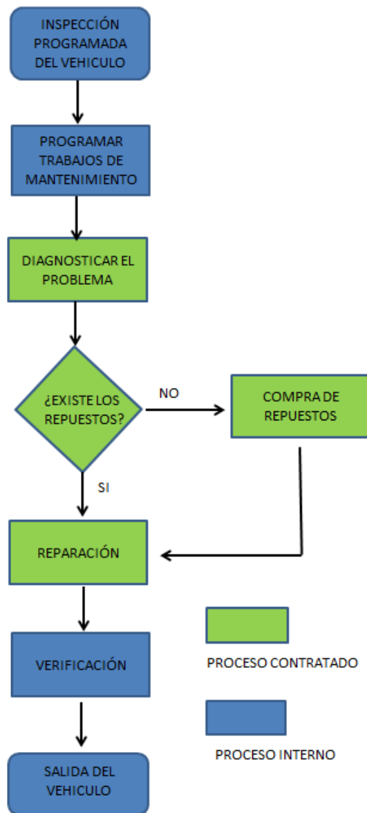
Figura 18. Proceso de Mantenimiento Eléctrico
