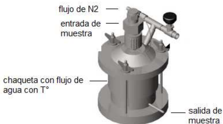
Figura 29: Esquema de Modelo de Extrusor utilizado para sintetizar las LUV's. Imagen modificada de www.northernlipids.com .
