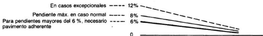
**Figura N° 12 Pendientes admisibles para el recorrido óptimo de los peatones (Printz, 1984B).** Situación que torna relevante frente al desplazamiento físico-temporal peatonal que se condiciona por la topografía.
