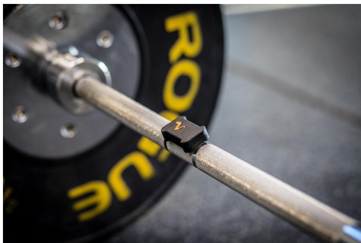
Figura 5. Dispositivo VmaxPro basado en IMU que se ancla a la barra.
