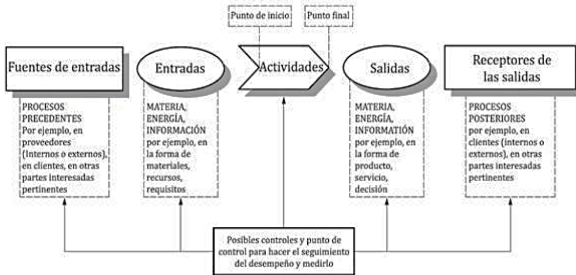
Figura 4. Elementos de un Proceso
