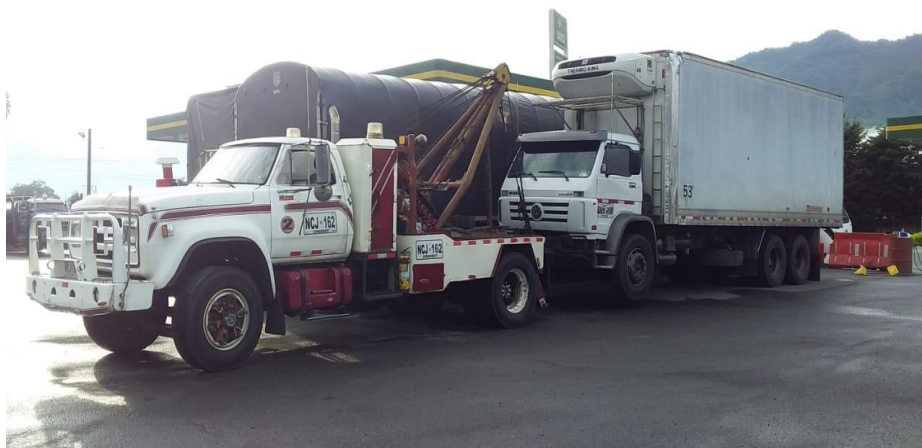
Figura 13. Modelo de grúa de gancho y cadena del parque automotor de Grupo transgruas s.a.s Fuente: Grupo transgruas (2021)
