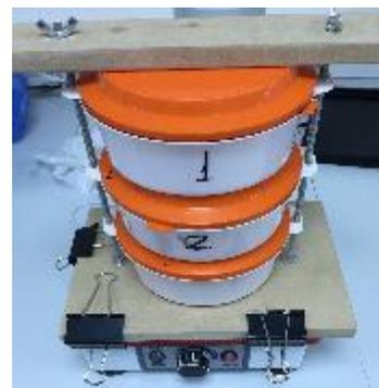
Ilustración 7 - Montaje tamices 1, 2 y 3
