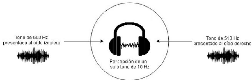
*Figura 2. Integración binaural de dos tonos puros de 500 Hz y 510 Hz en un solo tono que será la diferencia de frecuencias entre ambos tonos, en este caso de 10 Hz.*
