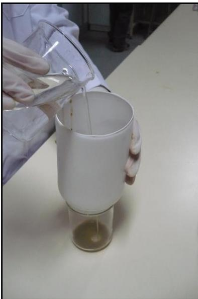
**Paso 3.** Tamizar la muestra, agregando agua.
