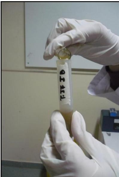
Eliminar sobrenadante y vertir sedimento a tubo de centrifuga hasta 10 ml.
