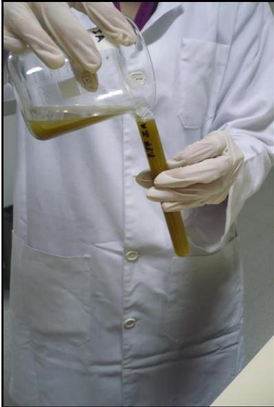
**Paso 4.** Eliminar el sobrenadante y el sedimento vertirlo a un tubo de 22 ml
