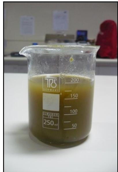
completar volumen de 200ml y decantar por 20 min.
