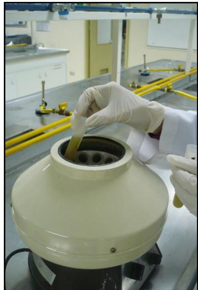
**Paso 6.** Centrifugar por 10min a 1500 r.p.m.
